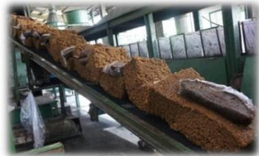
ยางคอมพาวด์เป็นผลผลิตจากการแปรรูปยางขั้นต้น ซึ่งวัตถุดิบยางแปรรูปที่ใช้มียางแผ่นรมควัน ยางแท่ง STR20 และยางสังเคราะห์ โดยยางแผ่นรมควันได้มาจากการนำยางแผ่นดิบมาเข้าเตารมควัน โดยยางแผ่นดิบนั้น ได้จากการนำน้ำยางสดมาใส่ในตะกุงจากนั้นจึงเติมน้ำเพื่อเจือจางน้ำยางให้มีปริมาณเนื้อยางแห้งเหลือเพียงร้อยละ 12-18 ก่อนเติมกรดเพื่อให้ยางจับตัวกันและแยกตัวออกจากน้ำ หลังจากนั้นจึงนำไปรีดให้เป็นแผ่นด้วยเครื่องรีดยางแผ่น ล้างน้ำและตากทำให้แห้ง ส่วน
